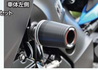
② 車体左側 左右セット レーシングスライダー φ60 フレーム(アルミベース+ジュラコン) 各¥12,000
