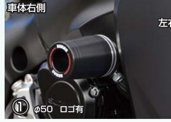
① 車体右側 左右セット レーシングスライダー φ50 フレーム(アルミベース+ジュラコン) 各¥10,000
