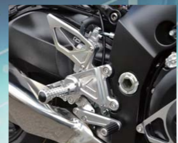
バックステップ (312-302-000) 4ポジション UP:35mm/45mm BACK:00mm/10mm アルミ削り出し製 ※STDのブレーキスイッチがそのままご利用いただけます。 ※ステップバーの組み替えも可能です。(MFJ-Aに限ります。)
