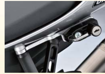
ヘルメットホルダー (603-276-000**) 各¥9,500 アルミ削り出し製 ヘルメットロックと専用ステーのセット ※**部分には色番が入ります。 (SS) アルミステア/シルバー ヘルメットロック/メック (SB) アルミステア/シルバー ヘルメットロック/ブラック (BS) アルミステア/ブラック ヘルメットロック/メック (BB) アルミステア/ブラック ヘルメットロック/ブラック
