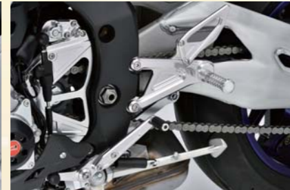
バックステップ (312-276-000) 各¥75,000 4ポジション UP: 30mm/40mm BACK: 15mm/25mm アルミ削り出し製 純正のブレーキスイッチがそのままご利用可能です。 ※ステップバーの組み替えも可能です。(MFJ-AIに限りです。) ※逆チェンジ可能
