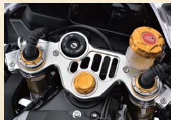
トップブリッジ (321-276-000) 各¥39,500 アルミ削り出し製 アルミ削り出しセンターナット付(カラー:シルバーのみ) ※ケーブル類は純正をそのまま使用できます。 ※ハンドルバーの取付角度によっては車体と干渉しますので干渉しない位置で取付けてください。
