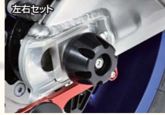
リアアクスルプロテクター (345-276-000) 各¥12,500 プロテクターサイズ: φ60 左右セット ジュラコン製 アルミ製シャフト使用 ※方角の転倒時に、アクスルシャフト部分及び、ブレーキまわりを保護します。
