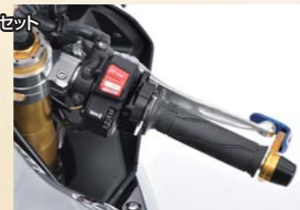
ハンドルSET (321-276-001) 各¥40,000 アルミ削り出し製 左右セット 垂れ角: 10°(ノーマル) 11° 高さ: ハンドルをクランプしている部分で純正と同じ。垂れ角分純正より下がります。 垂れ角分純正より下がります。 トップブリッジとハンドルを固定するステーを取り外せば自由に絞り角を設定することができます。 (ハンドルが車体に干渉しない範囲となります) ※ケーブル類は純正をそのまま使用できます。 ※純正トップブリッジに取付可能。
