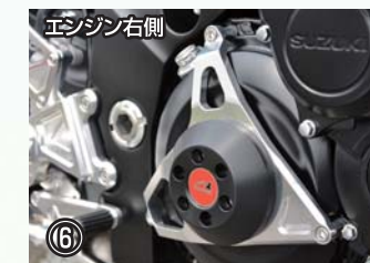
エンジン右側 ⑥ レーシングスライダー クラッチ タイプ2(アルミベース+ジュラコン) 各¥29,500 (342-302-005) ジュラコン/ホワイト (342-302-005B) ジュラコン/ブラック エンジン右側のクラッチカバーのボルトと共締めで取り付けます。 ※走行条件等によっては車両のバンク角が損なわれる場合がございます。ご注意ください。
