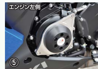
エンジン左側 ⑤ レーシングスライダー ジェネレーターC(アルミベース+ジュラコン) 各¥18,500 (342-302-006) ジュラコン/ホワイト (342-302-006B) ジュラコン/ブラック エンジン右側のジェネレーターカバーのボルトと共締めで取り付けます。 ※走行条件等によっては車両のバンク角が損なわれる場合がございます。ご注意ください。
