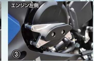
車体左側 左右セット ③ レーシングスライダー ジェネレーターA(アルミベース+ジュラコン) 各¥10,000 (342-302-003) ジュラコン/ホワイト (342-302-003B) ジュラコン/ブラック エンジン左側のジェネレーターカバーのボルトと共締めで取り付けます。 ※走行条件等によっては車両のバンク角が損なわれる場合がございます。ご注意ください。
