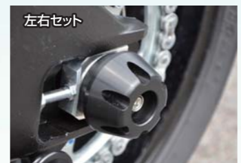
リアアクスルプロテクター (345-302-000) ¥11,500 プロテクターサイズ:φ60 ジュラコン製 アルミ製シャフト使用 ※万が一の転倒時に、アクスルシャフト部分及び、ブレーキまわりを保護します。
