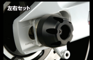
リアアクスルプロテクター ¥11,340 カラー-ホワイト/ブラック リアのアクスルナットを保護します。
