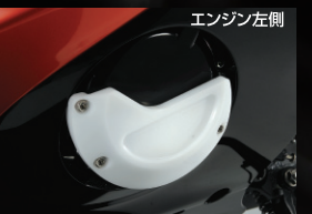
レーシングスライダージェネレーターBタイプ (オールジュラコン製) ¥16,275
