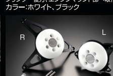
レーシングスライダー L+R SET TYPE-II ¥44,100 プレート部:アルミ削り出し/スライダー部:ジュラコン カラー:プレート部/シルバー、ブラック スライダー部/ホワイト、ブラック
