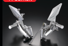
バックステップ ¥71,400 4ポジション BACK:25/35mm UP:40/50mm リンク式にすることにより、純正同様のシフトロッドの取回しが可能です。 STDブレーキスイッチ取り付け可能。
