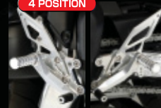
バックステップ ¥71,400 アルミ削り出し/4ボジション BACK:10mm/20mm UP:25mm/35mm ※ナイフエッジタイプペダル採用 ※油圧ストップスイッチ付属 ※プラス¥5,000でカラーオーダー承ります。
