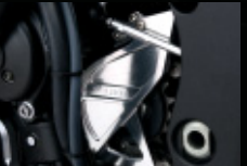
スプロケカバー ¥16,800 ※アルミ削り出し、2ピース構造
